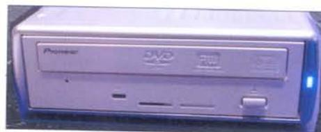
Das Dual-Layer-DVD-Laufwerk von Pioneer erhöht die Kapazität einer Disc auf über 9 GByte.
