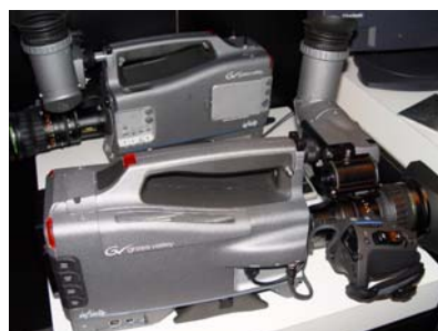
Bild 2. Infinity Digital Media Camcorder von Grass Valley zeichnet auf Compact Flash und REV Pro-Medien auf
