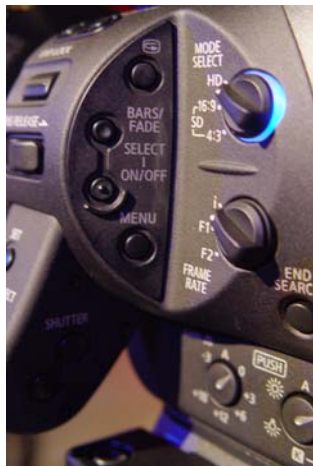
Bild 4. F1/F2 auf i-Mode-Umschalter des HDV-Camcorders XL H1 von Canon
