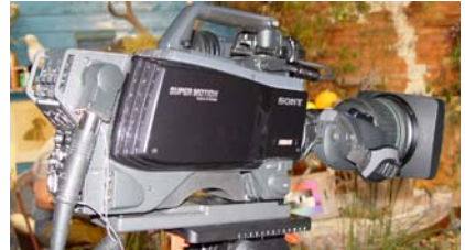
Bild 17. Sony Super Motion-HDTV-Kamera mit 1080i/150/180-Bildabtastung, die der 3-fachen Normalgeschwindigkeit entspricht
