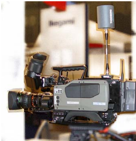
Bild 10. Drahtlose Tandberg-Übertragungstechnik an einer Ikegami HK-399PW
