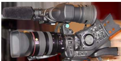
Bild 3. Canon XL H1 HDV-Camcorder mit interlace und F1/F2-Aufzeichnungsmöglichkeit (je 1,67 Mio. Pixel)
