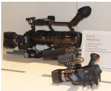
Bild 12. Sony HVR-A1E HDV-Camcorder – nur 670 gr Gewicht, 1/3 inch 3-Megapixel-CMOS-Chipsatz und 'Enhanced Imaging Processor (EIP)'
