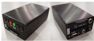
Bild 46. FieldPro DVR (127 mm x 82 mm x 34 mm) hat eine 2,5-inch-Festplatte und zeichnet im M-JPEG-Format (720x486 Pixel) auf
