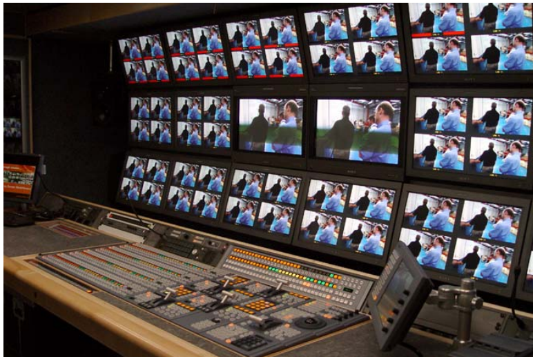
Blick in die Regie des neuen 24 Kamera HD-U-Wagens von tpc, der von Sony Professional Services UK gebaut wurde. Neben zahlreichem HD-Equipment von Sony (HDC-1500, SRW-5500, MVS-8000, MVE-800, usw.) kommen EVS XT-SloMotion-Systeme, eine Sirius Multiformat-Videokeuzschiene von Pro-Bel, Nexus Audiokreuzschiene von Stagetec und Intercom-Anlage von Huegl zum Einsatz. Alle Signalwege werden über den KSC-Manager von BFE verwaltet und gesteuert.
