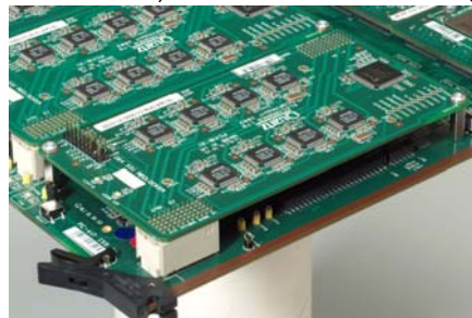
Bild 42. STP-Module können für zusätzliche Funktionen auf die Kreuzschienenkarten des Nexus-Systems von Quartz aufgesteckt werden
